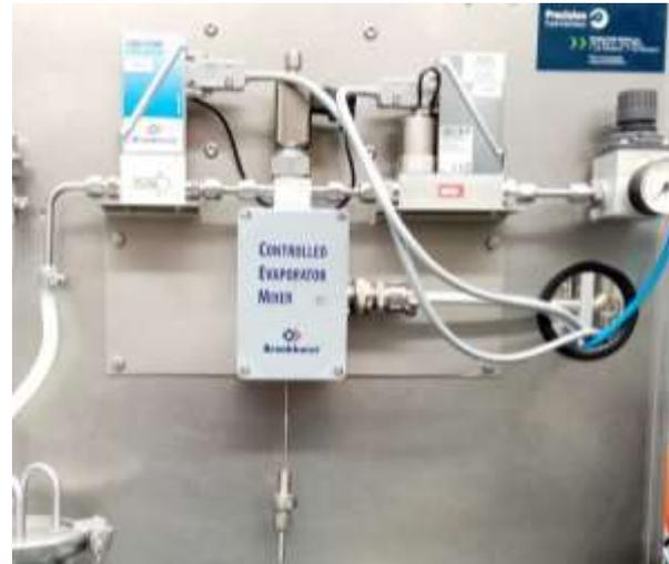
**CEM 3 way Mixing Valve and evaporator:** controllo del flusso della sorgente liquida e mescolamento con il flusso di gas carrier; scambiatore di calore per scaldare la miscela (Tmax: 200°C/Pmax: 100 bar).
